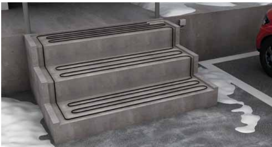
Резистивный кабель Tash подходит для установки на площадях различных форм и размеров. Одножильный кабель требует возврата к точке подключения, поэтому оба питающих кабеля заводятся в монтажную коробку. (Изображение приведено только для общего руководства)
